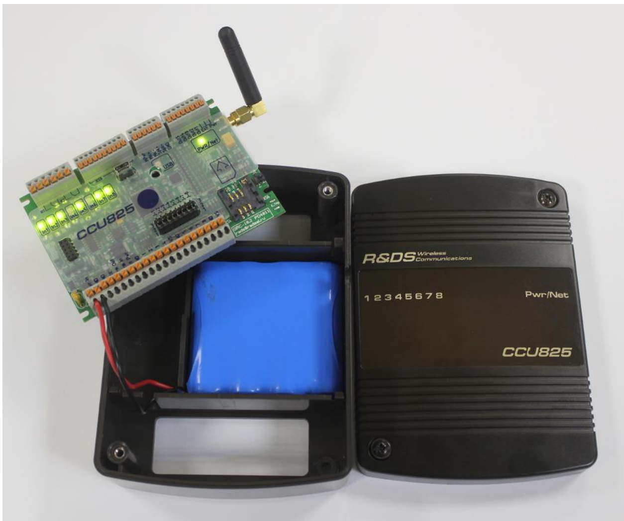
Рисунок 2.1 – Внешний вид GSM-контроллера CCU825
